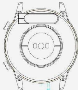
**⚠️** Il contatto simultaneo dei due pin del cavo USB e del conduttore può causare un cortocircuito e provocare ustioni.
